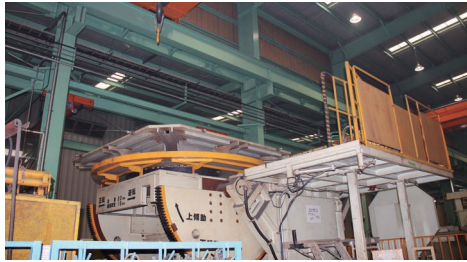
20トンまでの部品を溶接に最適な位置に 移動・固定できる溶接ポジションナ
