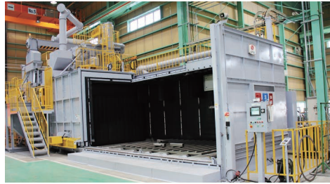
細かな粒体を金属部品に衝突させ、塗装前に 表面の錆を取り除くショットブラスト
